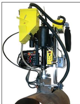
**Программируемый аппарат круговой сварки CWP-18** предназначен для одно- или многопроходной сварки муфт или форсунок на сосудах или куполообразных оголовках с использованием процесса сварки под флюсом, MIG или с порошковой проволокой в защитном газе. CWP-18 крепится на 3-х кулачковом патроне для сварки внешних диаметров 10-50 "(254-1270 мм).
