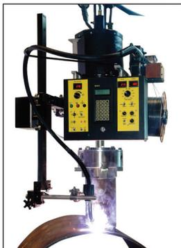
**Программируемый аппарат круговой сварки CWP-5** предназначен для одно- или многопроходной сварки муфт или форсунок с использованием процесса MIG или с порошковой проволокой, выполняет сварку диаметров 1-12 "(25-305 мм).
