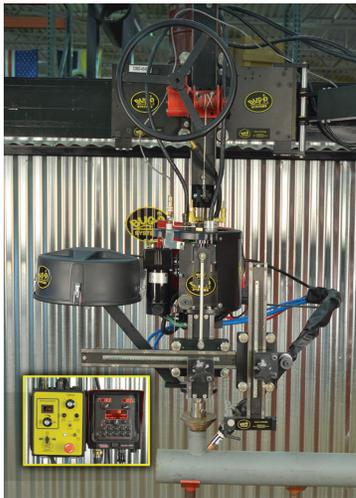
Аппарат круговой сварки DCW-5-L, оснащенный устройством под ачи проволоки Lincoln Electric Power Feed 84, может сваривать диаметры 1-12" (25,4-304,8 мм). Этот аппарат может использоваться для MIG, импульсной MIG и сварки порошковой проволокой. Он имеет запоминающее устройство на восемь процедур сварки и предварительно запрограммированные автоматические настройки для упрощения процесса.
