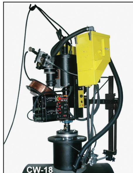
Аппарат круговой сварки CW-11 (CWO-1100) используется для сварки под флюсом, сварки сплошной и с порошковой проволокой на больших сосудах, куполообразных оголовках и плоских поверхностях. CW-11 имеет рабочий диапазон 10 "–50" (254-1270 мм) внешний диаметр отверстий без накрутки кабеля при многопроходной сварке. Дистанционное управление током и напряжением. Устройство использует проволоку диаметром от 0,353 "–3/32" (0,8-2,4 мм).
