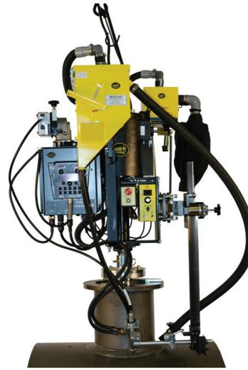
Аппарат круговой сварки DCW-18-L, оснащенный контроллером Lincoln Electric MAXsa 10 для Power Wave AC / DC 1000, может сваривать сопла диаметром 10-50 дюймов. Аппарат настроен для работы с погруженной дугой. Аппарат имеет запоминающее устройство на восемь процедур и удобные для пользователя элементы управления.
