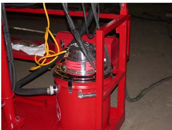
**Система рециркуляции флюса на базе вакуумной установки фирмы Weld Engineering**
